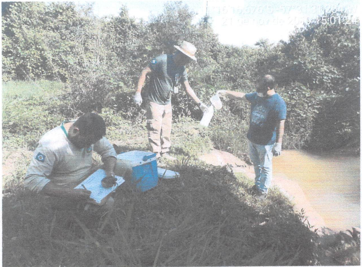
Foto 07: Vista da coleta a montante do lançamento final de esgoto tratado
