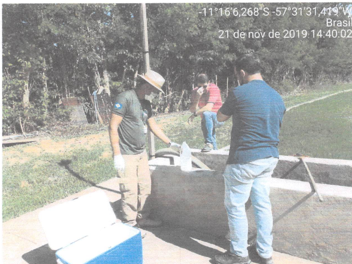
Foto 03: Vista da coleta na caixa desarenadora
